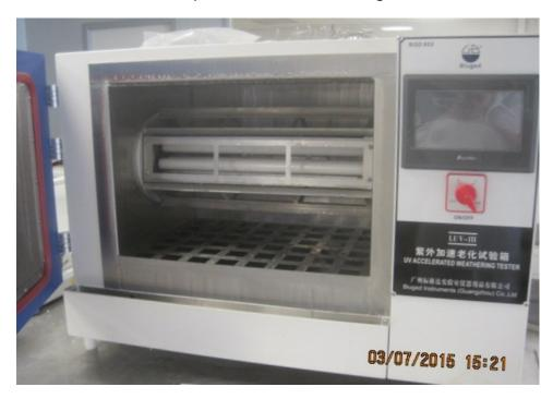
Les lampes sont des lampes UVB (313 nm). Ces lampes contiennent une part importante de rayonnement inférieur à 300 nm. La grande quantité d'énergie fournie par ces radiations en fait des lampes très exigeantes du point de vue du vieillissement. Bien au-delà des sollicitations fournies par la lumière solaire. Les échantillons sont placés à 55mm de la source d'UV.
