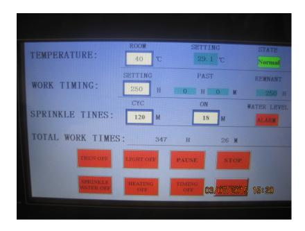
Les échantillons sont sortis après 15h de vieillissement et sont photographiés. Puis le test est relancé. Au terme des 250h les échantillons sont à nouveau photographiés et mesurés. Puis on procède à un lessivage des échantillons afin d'éliminer les salissures superficielles, et à nouveau on les photographie.
