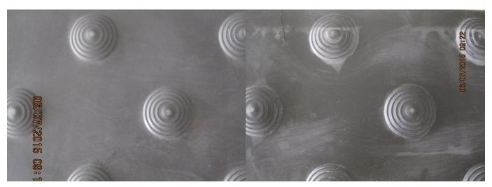
De plus, aucun des échantillons ci-dessus n'a subit de dégradation lors de ce test, pas de craquelures ou autre défaut de surface.
